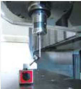
Medição do centro de rotação do eixo C
