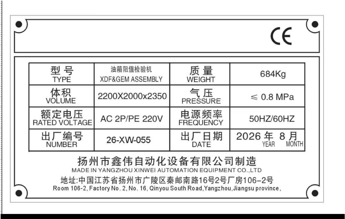
Testador de resistência GEM - foto da plaqueta de identificação do equipamento
